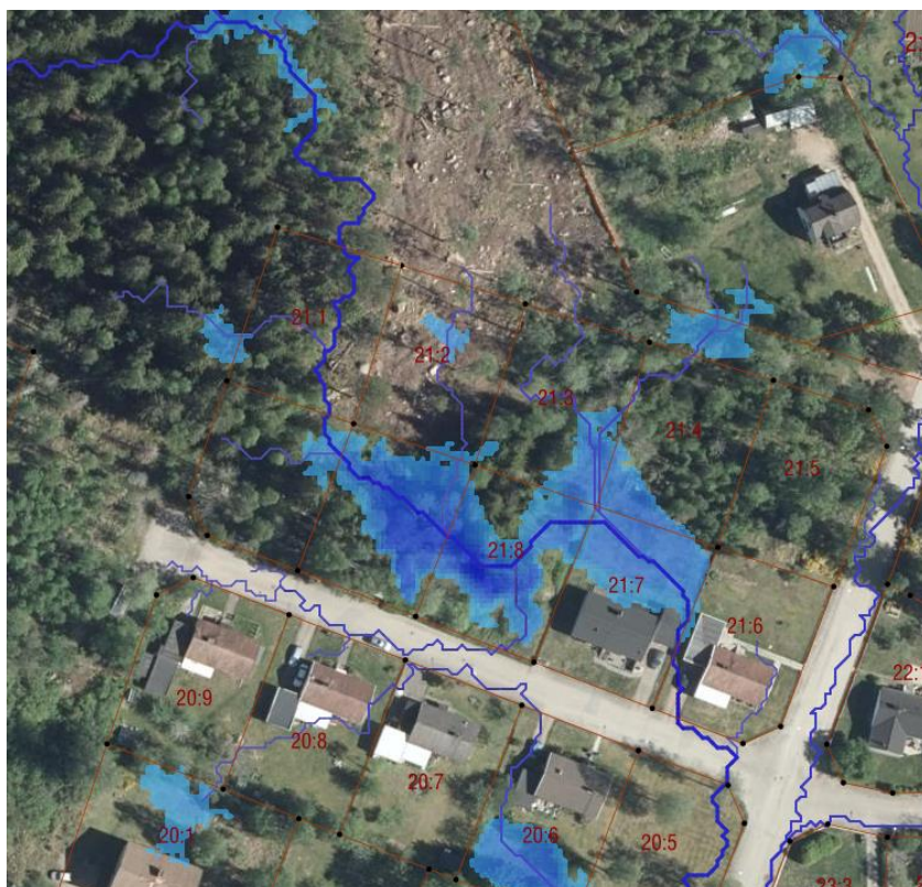
Figur 14: Exempel från Skruv med en instängd lågpunkt och en flödesväg som korsar obebyggda tomter.
